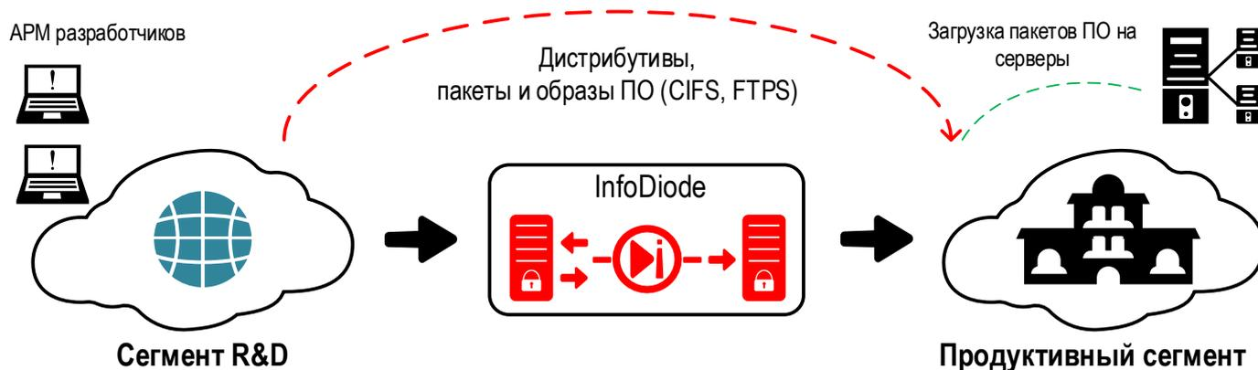
**Задача:** Гарантированно отделить сегмент разработки ПО (в том числе, сегмент подрядчиков и вендоров) от продуктивной среды банка и обеспечить при этом возможность передачи дистрибутивов и образов ПО в продуктивный контур.
