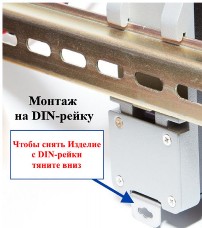
Рис.6. Монтаж на DIN-рейку
