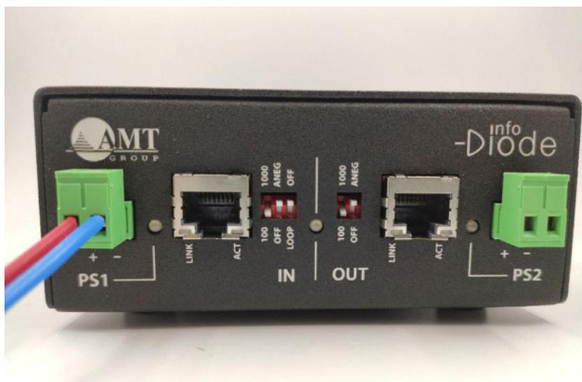
Рис. 8. Подключения электропитания к Изделию
