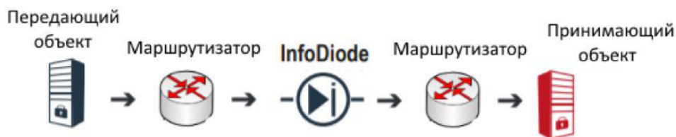
Рис. 13. Изделие установлено между граничными маршрутизаторами
