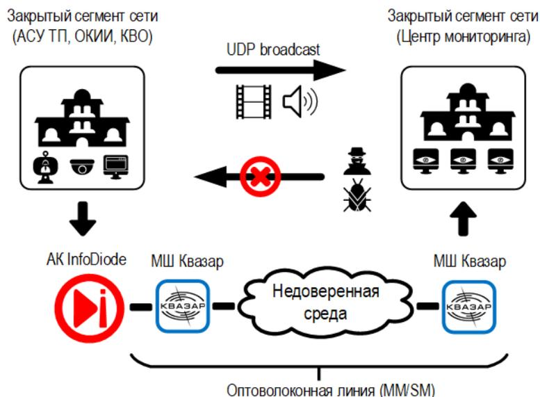
При использовании аппаратно-программных комплексов **InfoDiode** предполагается вынесение сервера Out-proxy во внешний сегмент с применением СКЗИ «Квазар» на волоконно-оптической линии от АК **InfoDiode** до Out-proxy.
