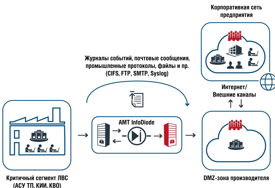
InfoDiode позволяет поставщикам/производителям в режиме реального времени контролировать функционирование поставленного ими оборудования, проактивно принимать меры реагирования. При этом обеспечивается гарантированная защита от компьютерных атак, которые могут быть организованы из сети поставщика/производителя.
