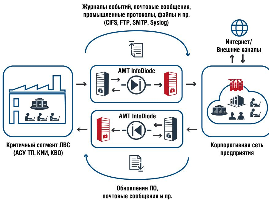
InfoDiode позволяет реализовать безопасную интеграцию технологической и корпоративной сети за счет создания полнофункциональной реплики данных в корпоративной сети, в то время как установка второго экземпляра InfoDiode в обратную сторону (внутрь технологического сегмента) обеспечивает доставку плановых обновлений антивирусных баз и программных продуктов, а также иных обновлений и баз сигнатур.
