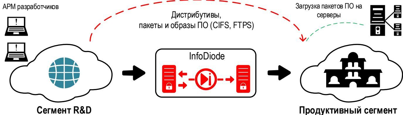
**Задача:** Гарантированно отделить сегмент разработки ПО (в том числе, сегмент подрядчиков и вендоров) от производственной среды банка и обеспечить при этом возможность передачи дистрибутивов и образов ПО в производственный контур.
