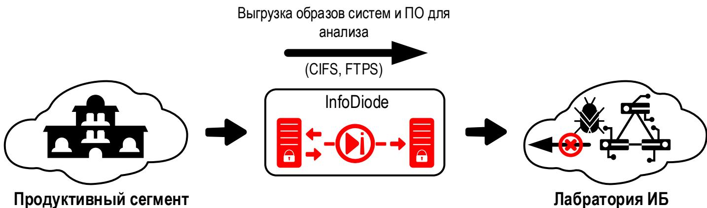
**Задача:** Исключить возможность заражения банковской сети из сети ИБ лаборатории, сохранив возможность копирования копий подозрительного ПО, виртуальных машин, образов систем для проверки на наличие вирусов и обнаружения угроз.
