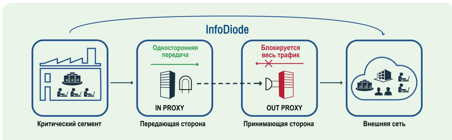
Реализована конструктивно и на аппаратном уровне, невозможно «включить» обратный канал
