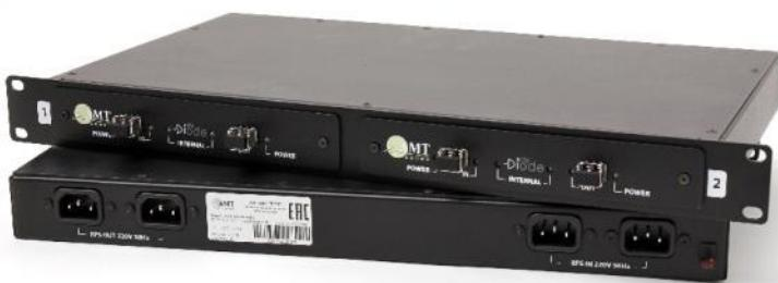
Базовое аппаратное решение для монтажа в стойку (два «диода» в одном). Сертифицировано ФСТЭК УД (4). Обеспечивает защиту на аппаратном уровне. Решает задачи по передаче UDP, Syslog, SPAN трафика потребителям за пределами доверенного сегмента, изолируя этот сегмент. Имеет резервирование по электропитанию.
