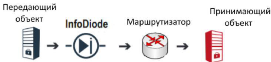
Рис. 12. Изделие установлено перед граничным маршрутизатором
