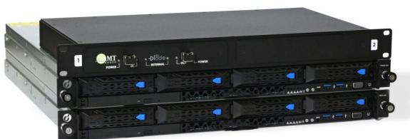
АПК InfoDiode PRO решает задачи по передаче файловых потоков, дистрибутивов, бэкапов баз данных, реплик виртуальных машин, электронной почты, видео и другого трафика за пределы доверенного сегмента целевым потребителям, изолируя этот сегмент.
