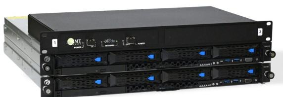
АПК InfoDiode PRO решает задачи по передаче файловых потоков, дистрибутивов, бэкапов баз данных, реплик виртуальных машин, электронной почты, видео и другого трафика за пределы доверенного сегмента целевым потребителям, изолируя этот сегмент.
