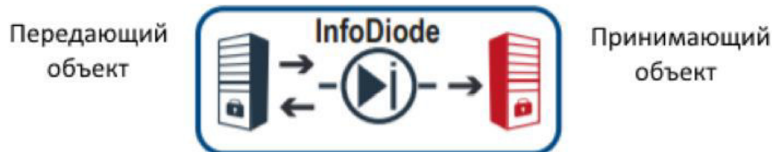
Рис. 10. Прямое подключение приемного и передающего компьютера
