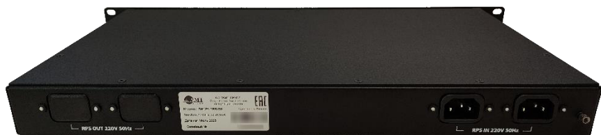
Рис. 4. Задняя панель AMTIR-1000-BK и AMTIR-2000-BK
