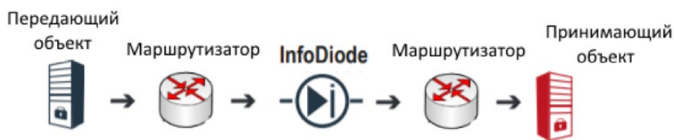
Рис. 13. Изделие установлено между граничными маршрутизаторами
