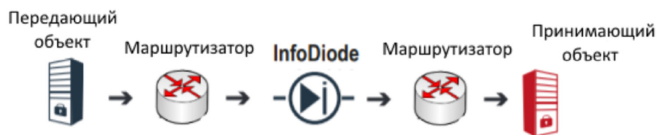
Рис. 13. Изделие установлено между граничными маршрутизаторами
