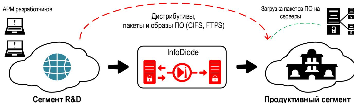
**Задача:** Гарантированно отделить сегмент разработки ПО (в том числе, сегмент подрядчиков и вендоров) от продуктивной среды банка и обеспечить при этом возможность передачи дистрибутивов и образов ПО в продуктивный контур.
